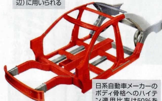
日系自動車メーカーのボディ骨格へのハイテン適用比率は50%を超えている
